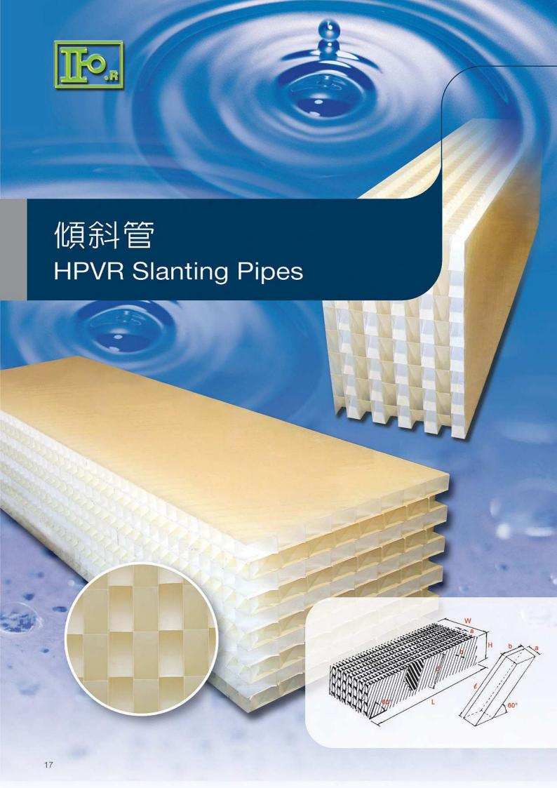
HPVR系列有較高的分子結構及光滑表面度,所以在沈澱、混凝、整流上均有一定優良的表現,是一般市售產品所無法相媲美的。獨特的Criss cross式結構設計能夠承受500公斤以上的自重力,大大提高使用的壽命和節省金錢的支出。HPVR系列的傾斜角度為60°H/h值為6,是單排式結構的2倍以上,所以在沈澱整流和二次混凝的作用之中,流體的膠羽粒子決不會附著於管壁上,所以能增加傾斜管功能的發揮。
