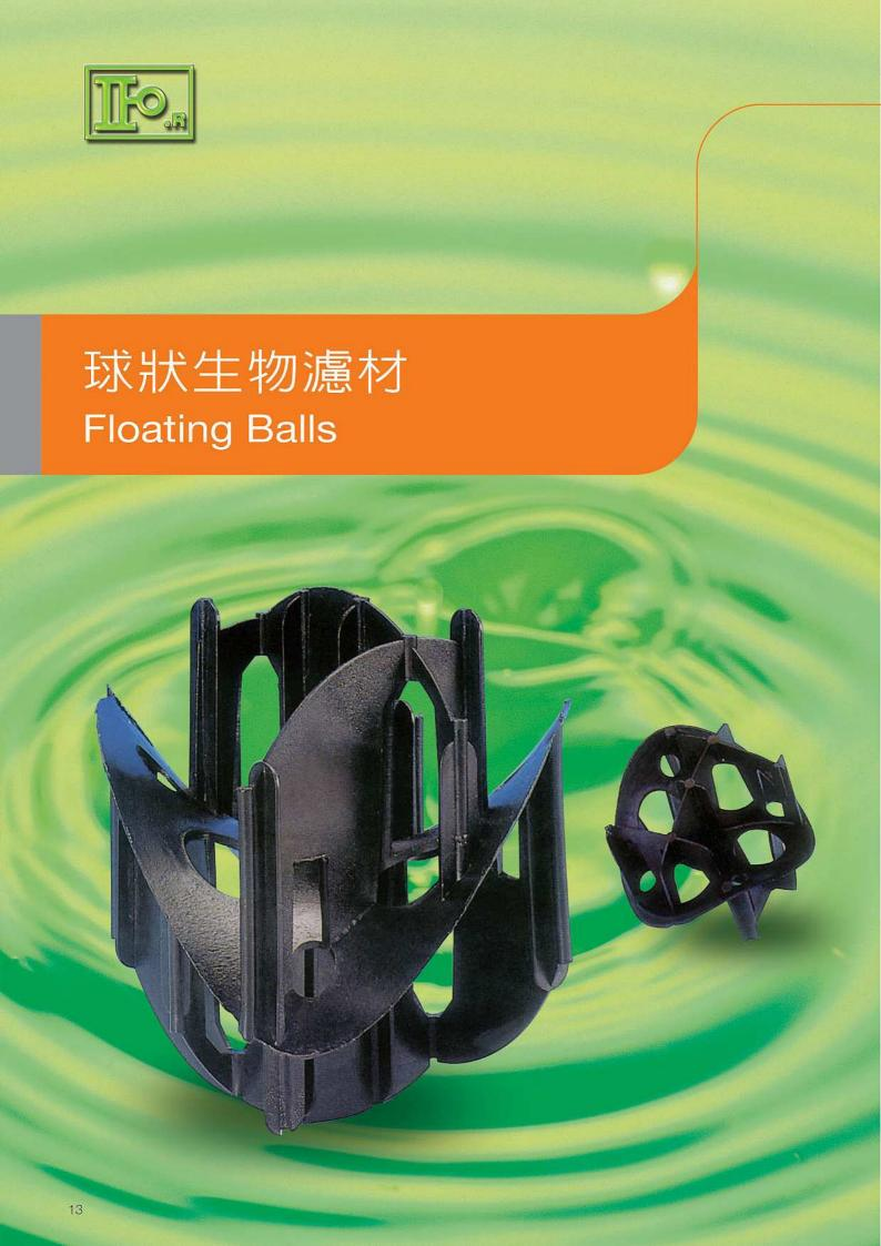
將<mark>浮動球散亂地投入</mark>接觸曝氣糟內,它們彼此間 會自然地形成固定濾床,不需要預做濾材支撐裝置。 因為浮動球比重小於1,填充的浮動球會像冰原一樣浮 在水中,大部分在水面下,再加上其特殊形狀互相組 合,浮力和壓力均衡結果,形成團塊狀的完全固定濾 床。
